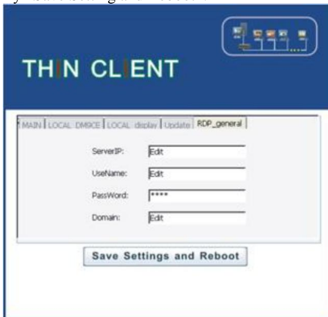
Рисунок 7. Настройка параметров RDP соединения
