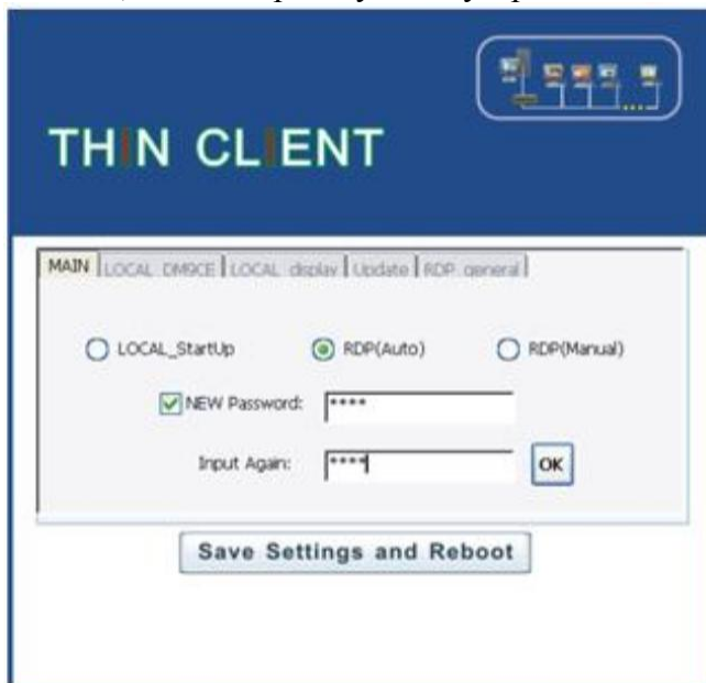
Рисунок 10. Установка пароля для настроек устройства.
