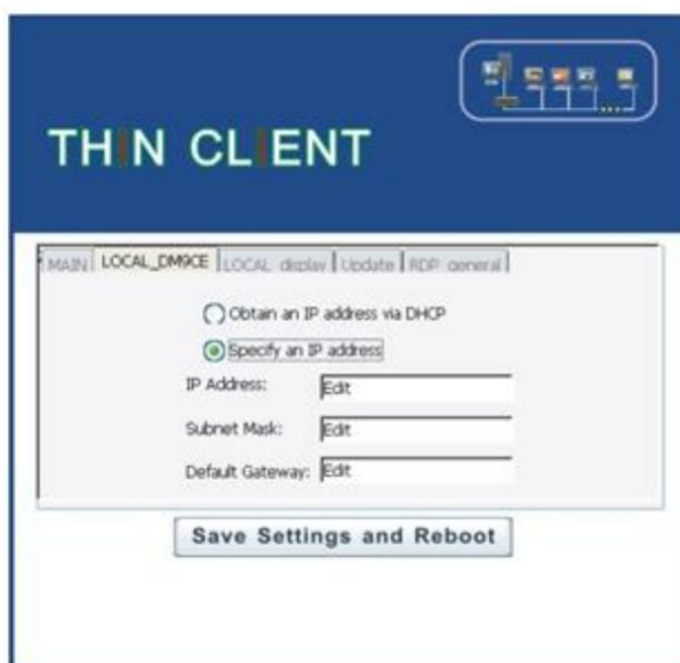
Рисунок 13. Окно установки сетевых настроек.
